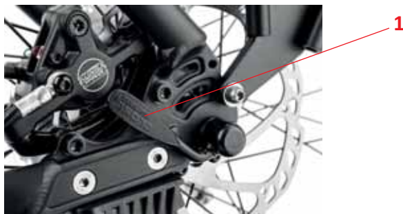
Abbildung 13: Vorschriftsmäßige Montage des Schnellspanners am Hinterrad
