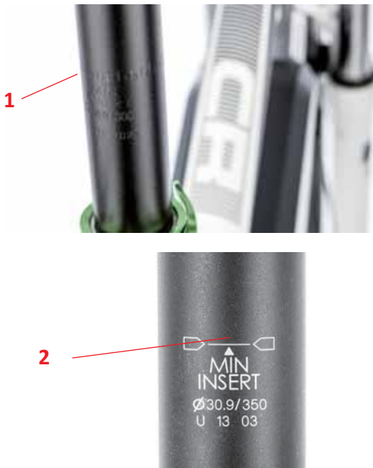
Abbildung 10: Markierungen zur Mindesteinstecktiefe der Sattelstütze
