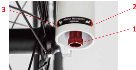
Abbildung 21: Einstellung der Federgabeldämpfung
