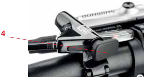
4 Sperrschieber, Federung geöffnet
