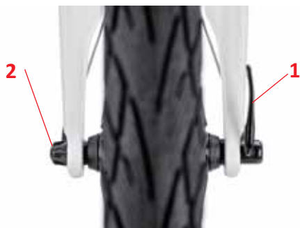
Abbildung 12: Vorschriftsmäßige Montage des Schnellspanners am Vorderrad
