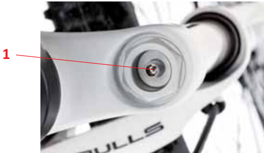
Abbildung 20: Einstellung des Gabelfülldrucks
